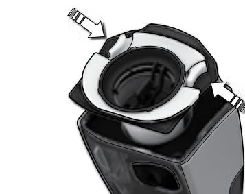
**4a. Rengjøring av støvbeholder og filtrer.** (Anbefales for hver femte rengjøring.) Løsne støvbeholderen og ta ut begge filtrene ved å trykke på frigjøringsknappene.
