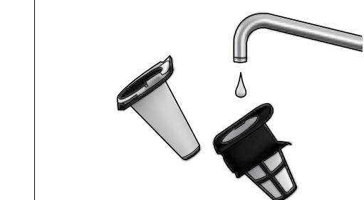
**4a. Pulizia dei filtri e del contenitore della polvere** (consigliata ogni 5 pulizie). Sganciare il contenitore della polvere ed estrarre entrambi i filtri premendo i pulsanti di rilascio.
