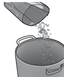
**1. Svuotamento rapido del contenitore della polvere.** Aprire lo sportello dell'aspirapolvere. Pulire il contenitore della polvere posizionando in corrispondenza della sua apertura il flessibile di un altro aspirapolvere.
