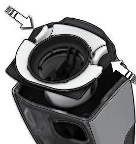
**3. Hitro čiščenje filtra za drobne delce** (priporočljivo ob vsakem čiščenju). Odstranite zbiralnik za prah, pet- ali šestkrat povlecite in spustite vzmet, da odstranite prah.
