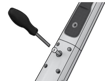
**2. Griff durch Anziehen der mitgelieferten Feststellschraube sichern. Schraubendreher oder Münze verwenden.**
