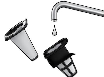
**4b. Beide Filter trennen.** Staubbehälter und Filter können durch Abschütteln gesäubert oder mit warmem Wasser abgespült werden (*keinesfalls im Geschirrspüler*). Alle Teile müssen trocken sein, bevor sie in umgekehrter Reihenfolge wieder eingesetzt werden.
