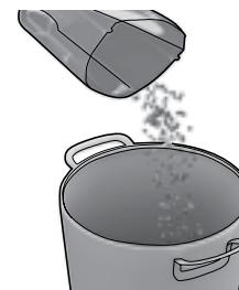
**2. Tømming av støvbeholderen.** Ta ut filtrene og tom innholdet i en søppelbøtte. Sett inn filtrene igjen, og trykk støvbeholderen på plass til du hører et klikk.
