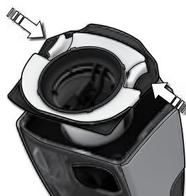
**4a. Reinigen von Staubbehälter und Filtern.** (Bei jedem 5. Reinigen empfohlen). Staubbehälter abnehmen, beide Filter durch Drücken der Freigabeknöpfe herausnehmen.
