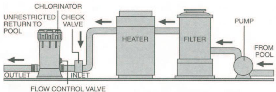
**Wird in die Druckleitung eingebaut.**
