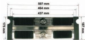
Geteilte Leiter aus Edelstahl 1.4301 - bestehend aus 2 Griffbögen und Stufenteil. Ober- und Unterteile haben einen Holmdurchmesser von 43 mm und werden angeflanscht. 4 x Flansche für Griffbögen im Lieferumfang enthalten, die Gegenflansche für Wandeinbau des Unterteils bei Folienbecken zusätzlich bestellen. Die Stufen lassen sich einfach selbst gegen Sicherheitsstufen 187 x 507 mm Außenmaß austauschen.
